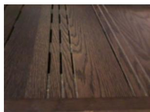
Стеновые панели на огнестойкой ЦСП-основе, натуральный шпон дуб, мореный и лакированный, степень глянца 10, темно-серая основа, спецдизайн перфорации Perfo-Linear Random, акустическая ткань на обороте размеры 3090x600x12мм. Кант соединения 3/В.
