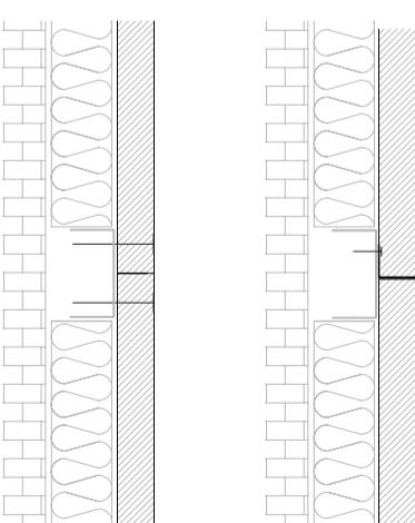
Монтаж на саморез      Монтаж на TL-профиль
