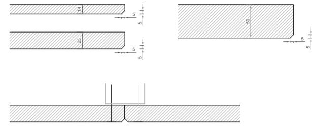
Монтаж на саморез (прямой монтаж)
