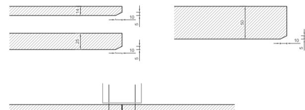
Монтаж на саморез (прямой монтаж)
